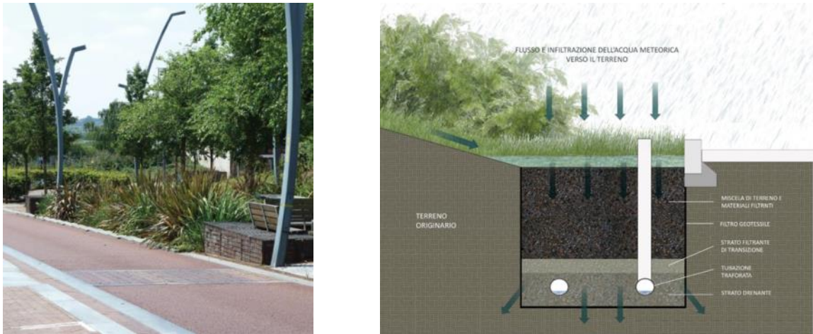
Figura 6. Sinistra: esempio area di bioritenzione (Woods Ballard et al. 2015. “The Suds Manual”). Destra: Tipologico area di bioritenzione (Linee guida sull’adozione di tecniche di drenaggio urbano sostenibile per una città più resiliente ai cambiamenti climatici del Comune di Bologna, 2018)
