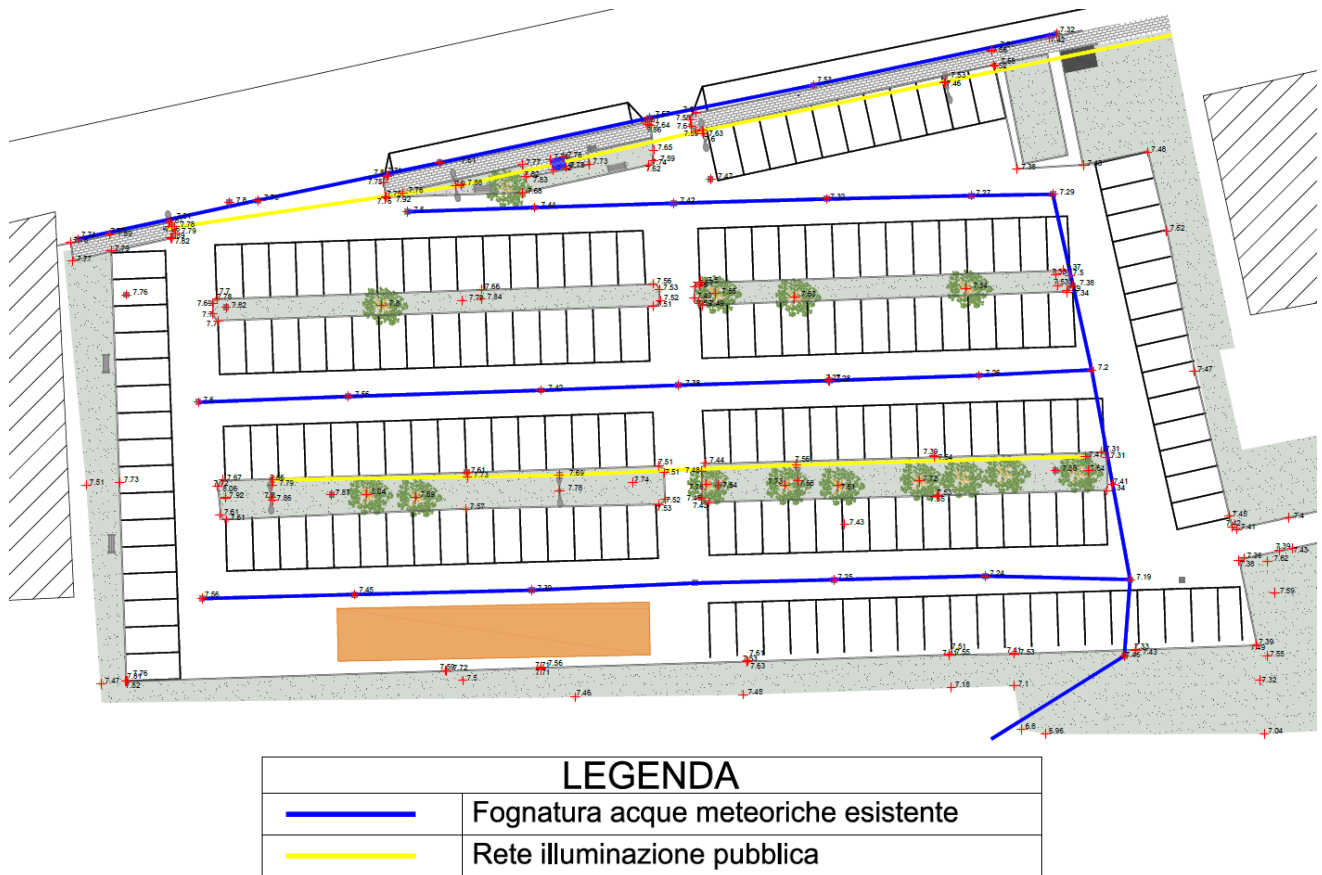
Figura 8. Planimetria dello Stato di Fatto con sottoservizi tracciati
