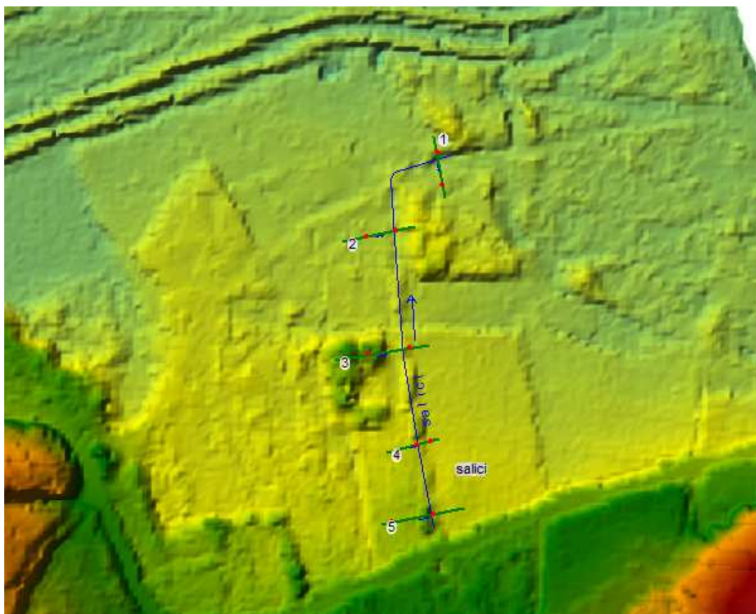
Figura 4. Tratto del Fosso dei Salici modellato con il software Hec-Hms
